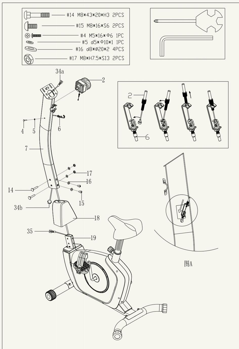
а. Вставьте вертикальную стойку (7) через кожух рулевой опоры (18), подключите провод (6) к вертикальной стойке (7).
